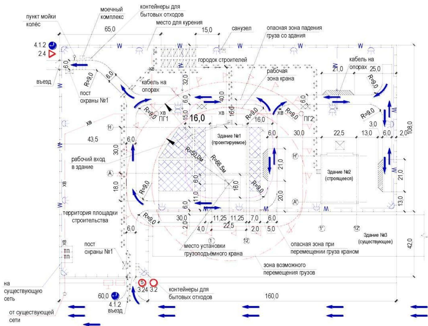
Рис. 30. Схема сетей временного водоснабжения строительной площадки
