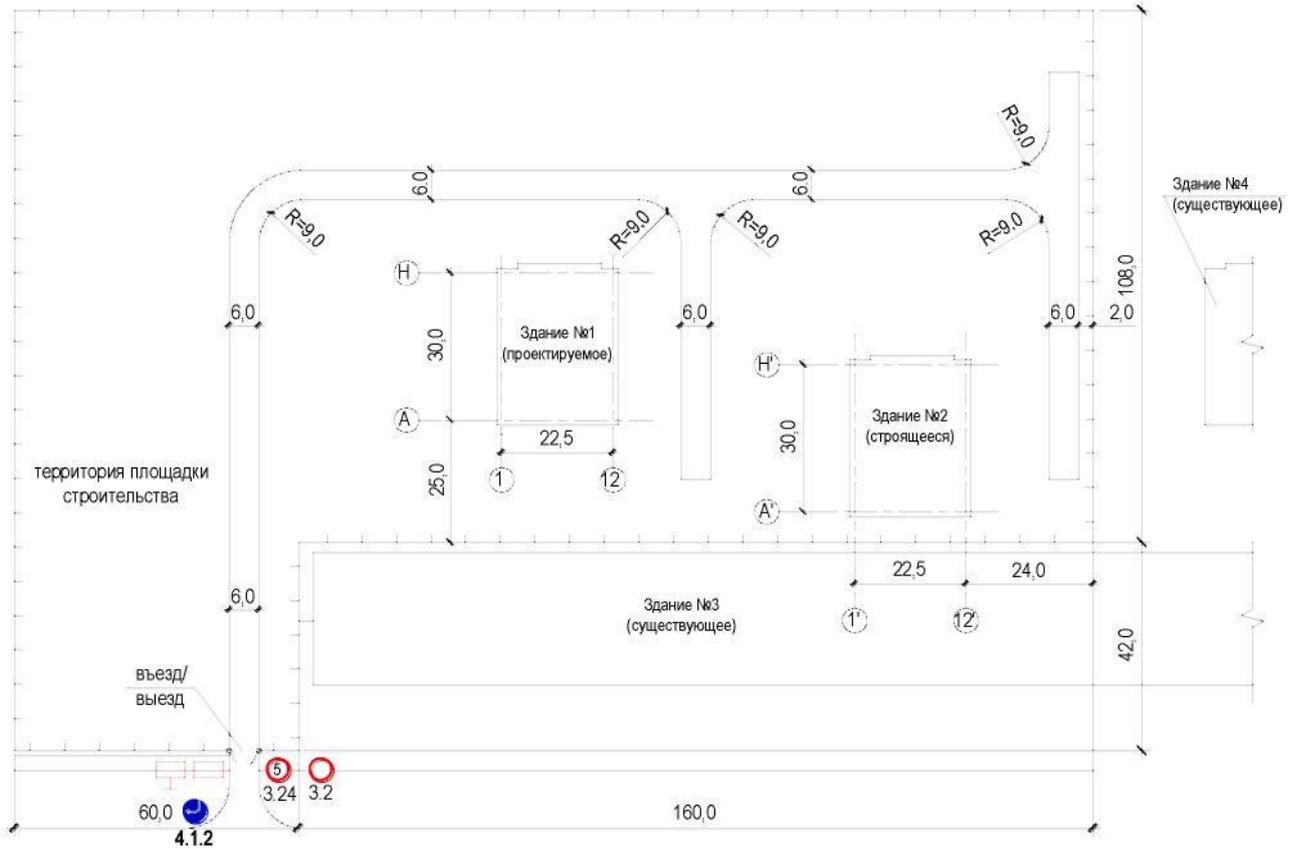
Рис. 6б. Стройгенплан с тупиковыми дорогами
