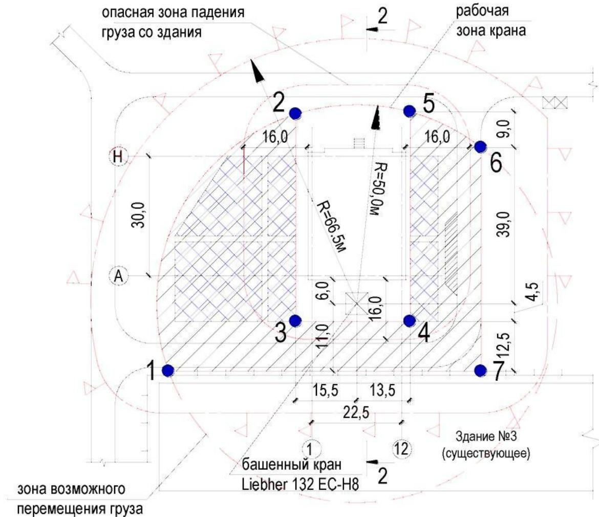
Рис. 34. Технологическая схема на монтаж каркаса здания
