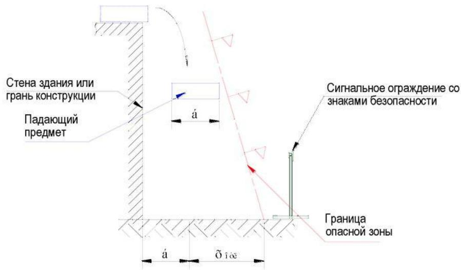
Рис. 24. Определение границы опасной зоны вблизи строящегося здания.
