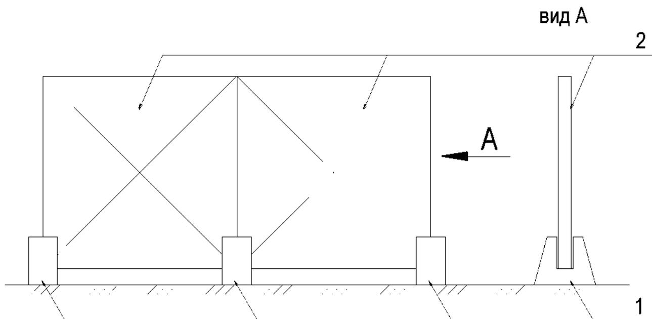
Схема ограждения строительных площадок из железобетонных панелей.
