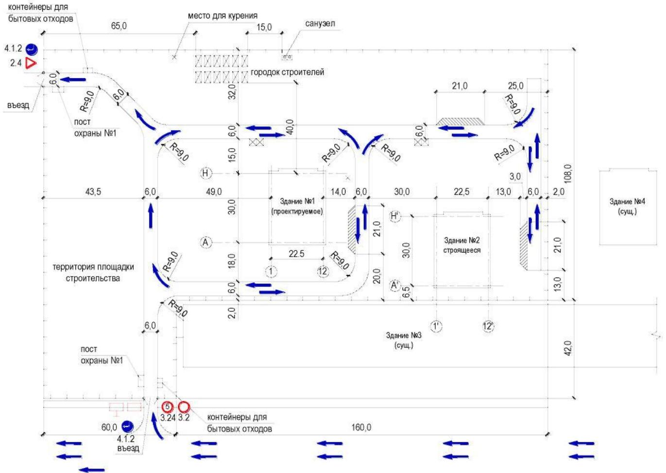
Рис. 11. Оснащение строительной площадки контейнерами для строительного и бытового мусора.
