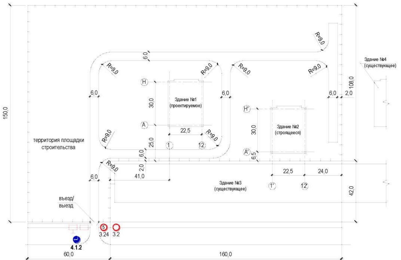
Рис. 6а. Стройгенплан с кольцевой внутривозрадной дорогой
