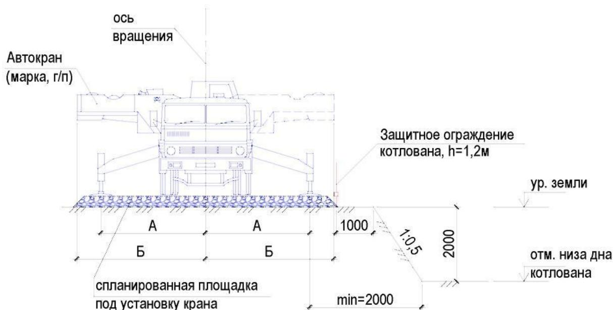
Рис. 16. Схема установки крана вблизи откоса котлована
