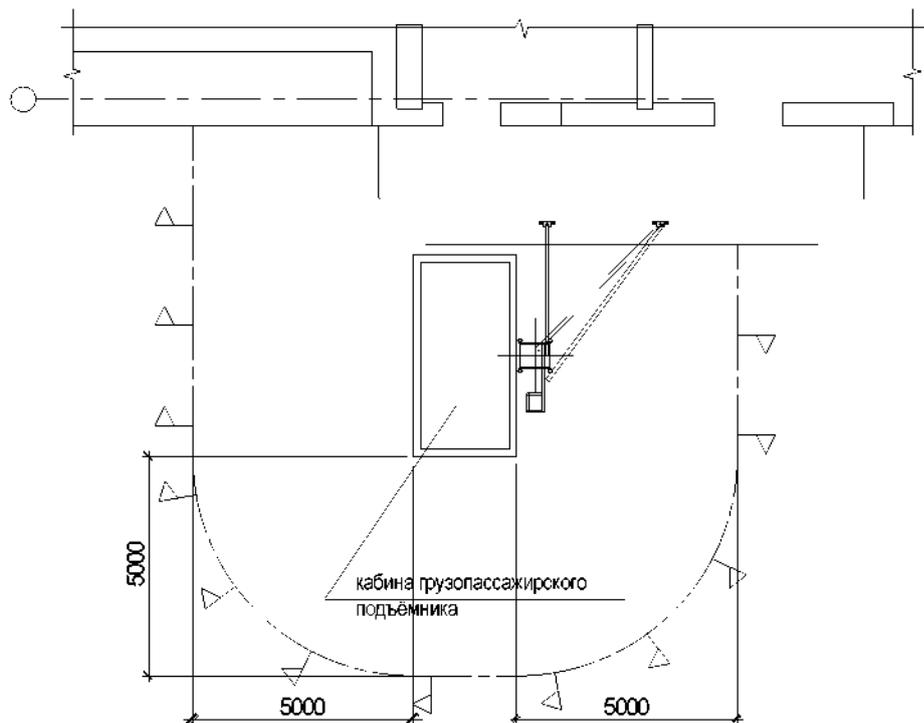
Рис. 22. Опасные зоны при работе грузопассажирского подъемника
