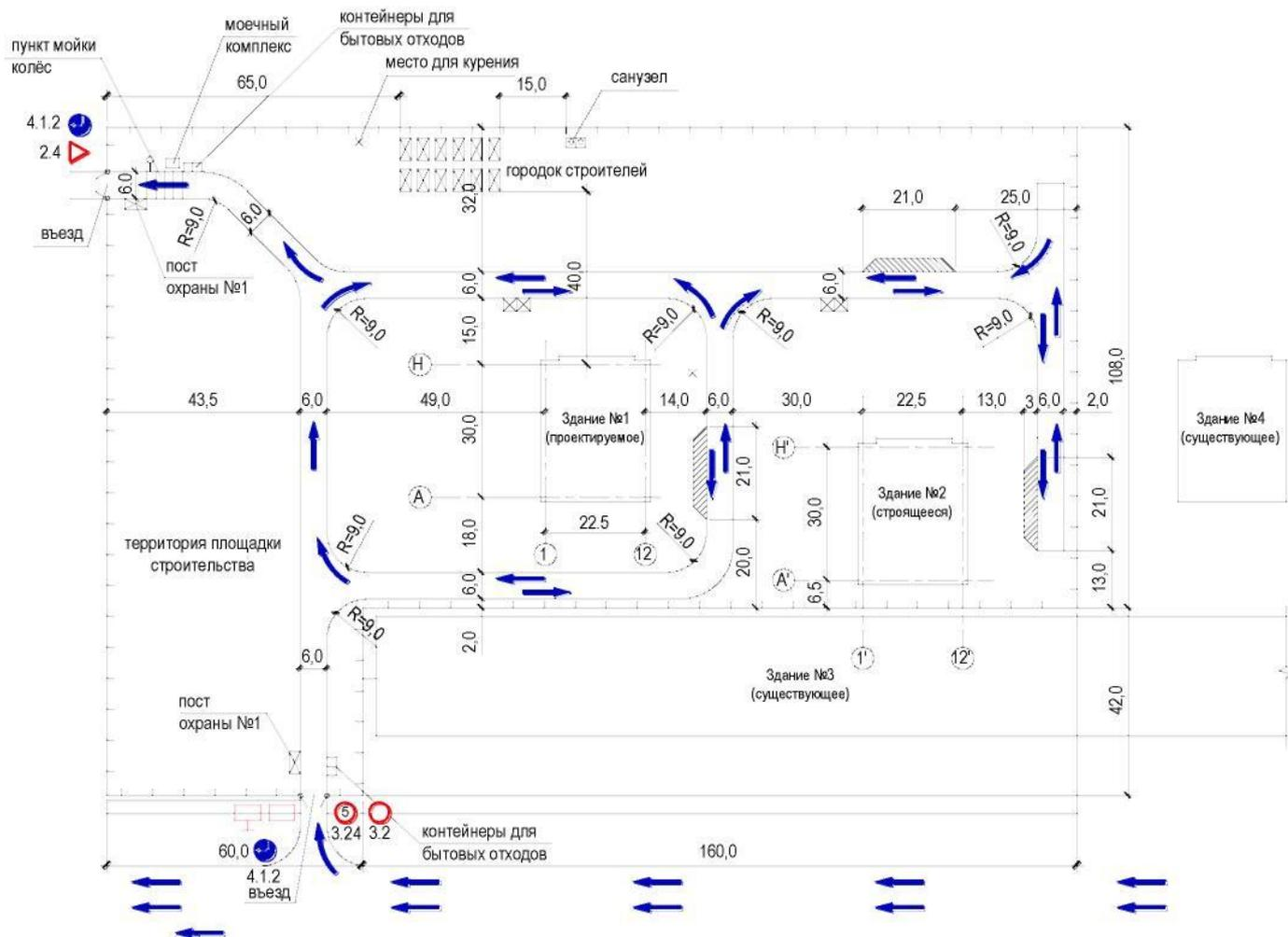
Рис. 14. Схема размещения пункта мойки колёс на стройплощадке
