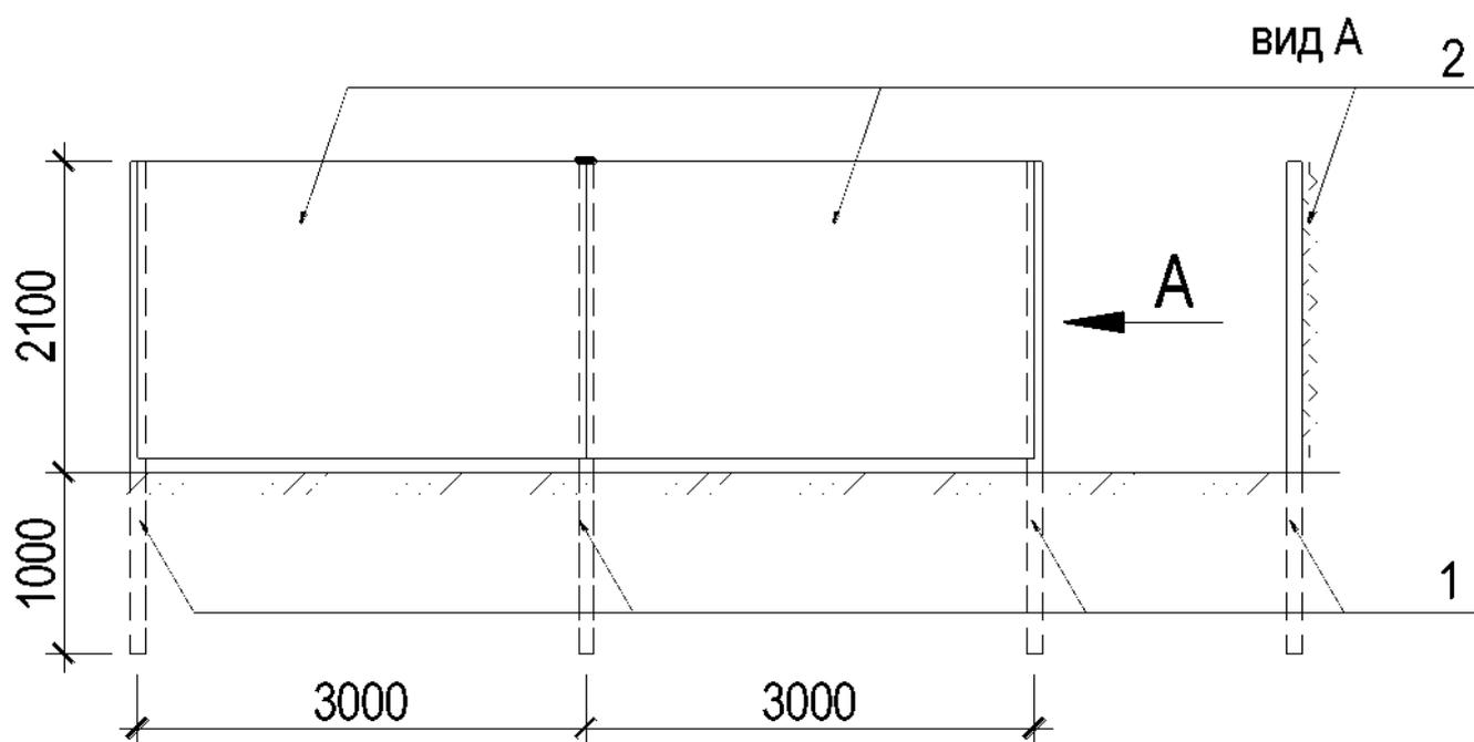
Схема сетчатого ограждения строительных площадок и ограждения из листов профилированного настила.
