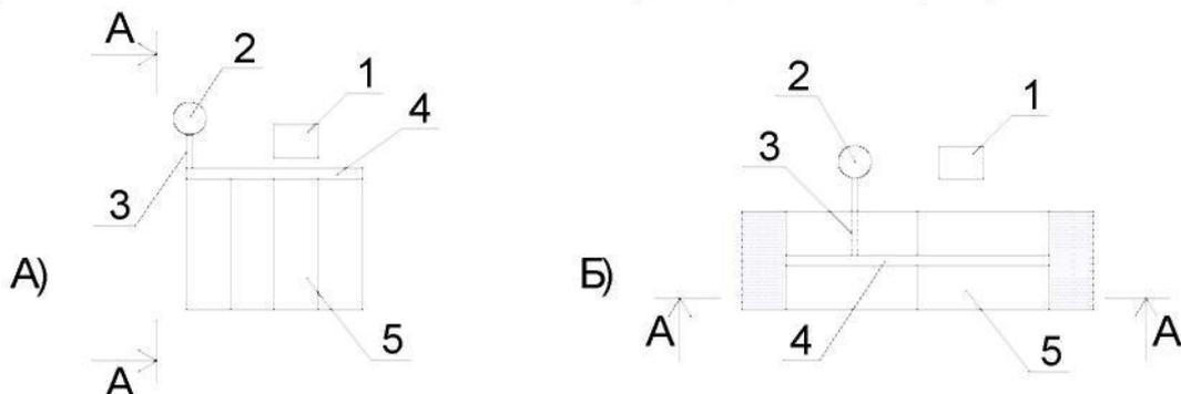
Рис. 12. Виды пунктов мойки колёс. А) в виде площадок; Б) в виде эстакад.
