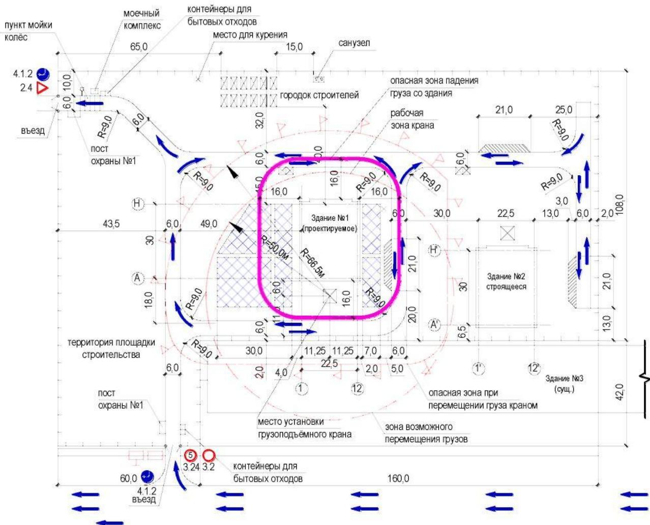
Рис. 25. Граница опасной зоны вблизи строящегося здания
