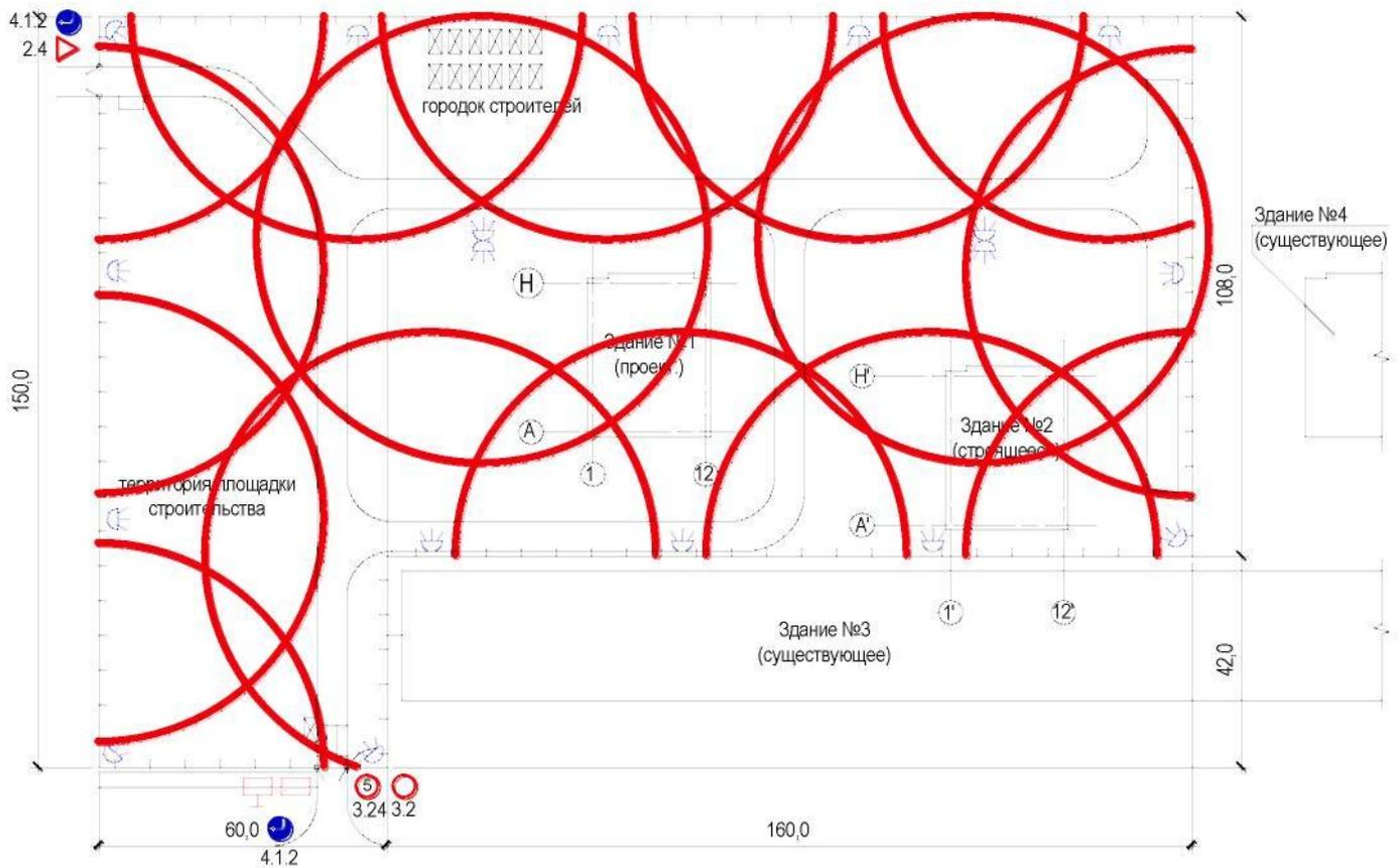
Рис. 28. Размещение осветительных мачт на территории строительной площадки.
