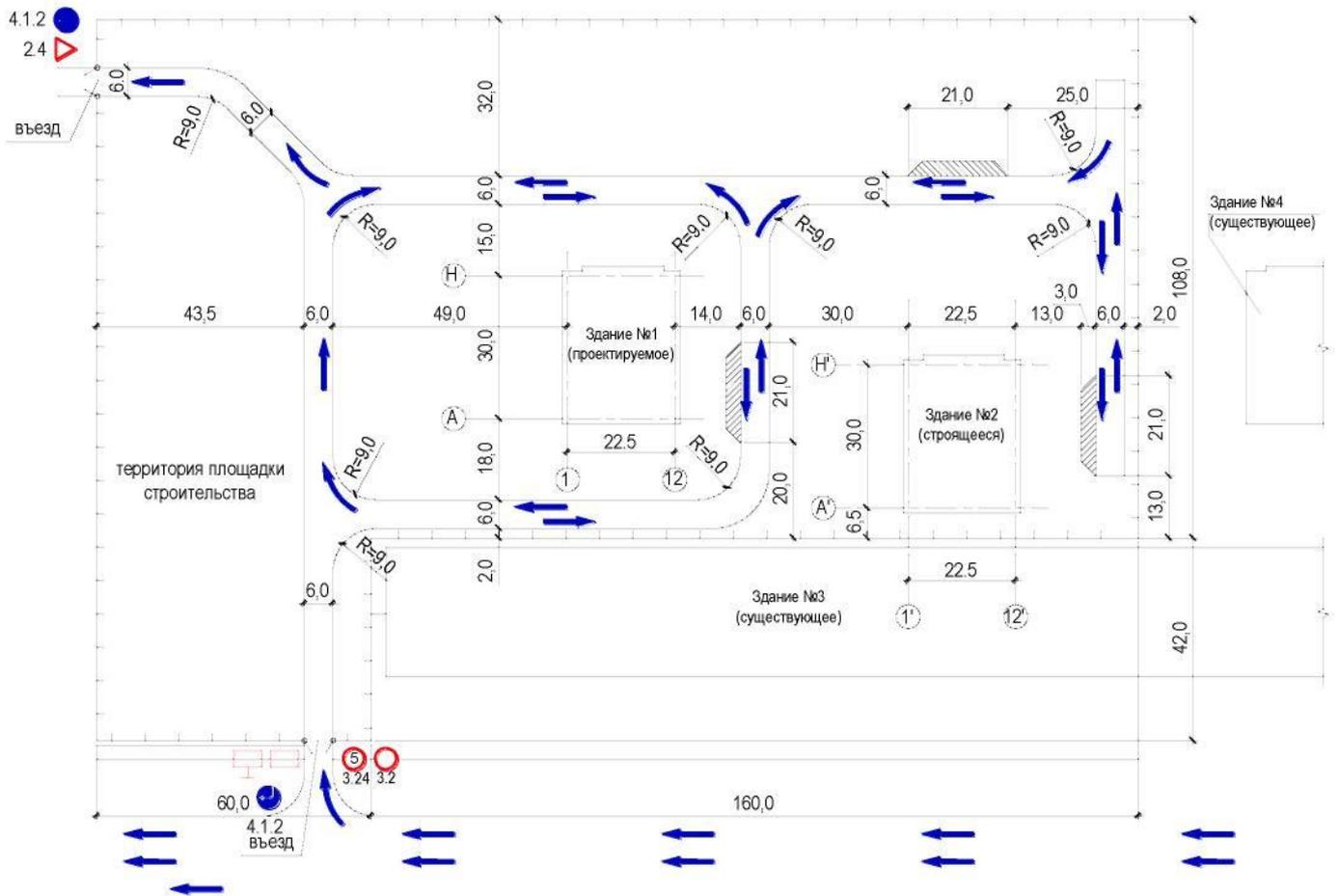
Рис. 8. Схема направления движения транспорта по строительной площадке
