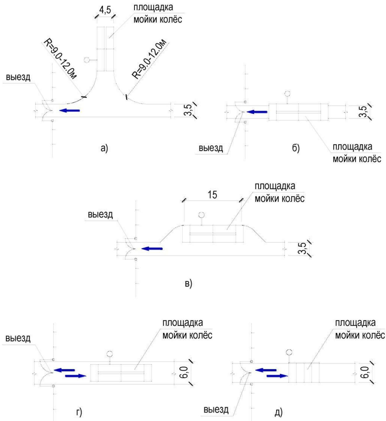
Рис. 13. а, б, в) - при одностороннем движении транспорта, г, д) – при двустороннем движении транспорта и совмещении въезда с выездом.
