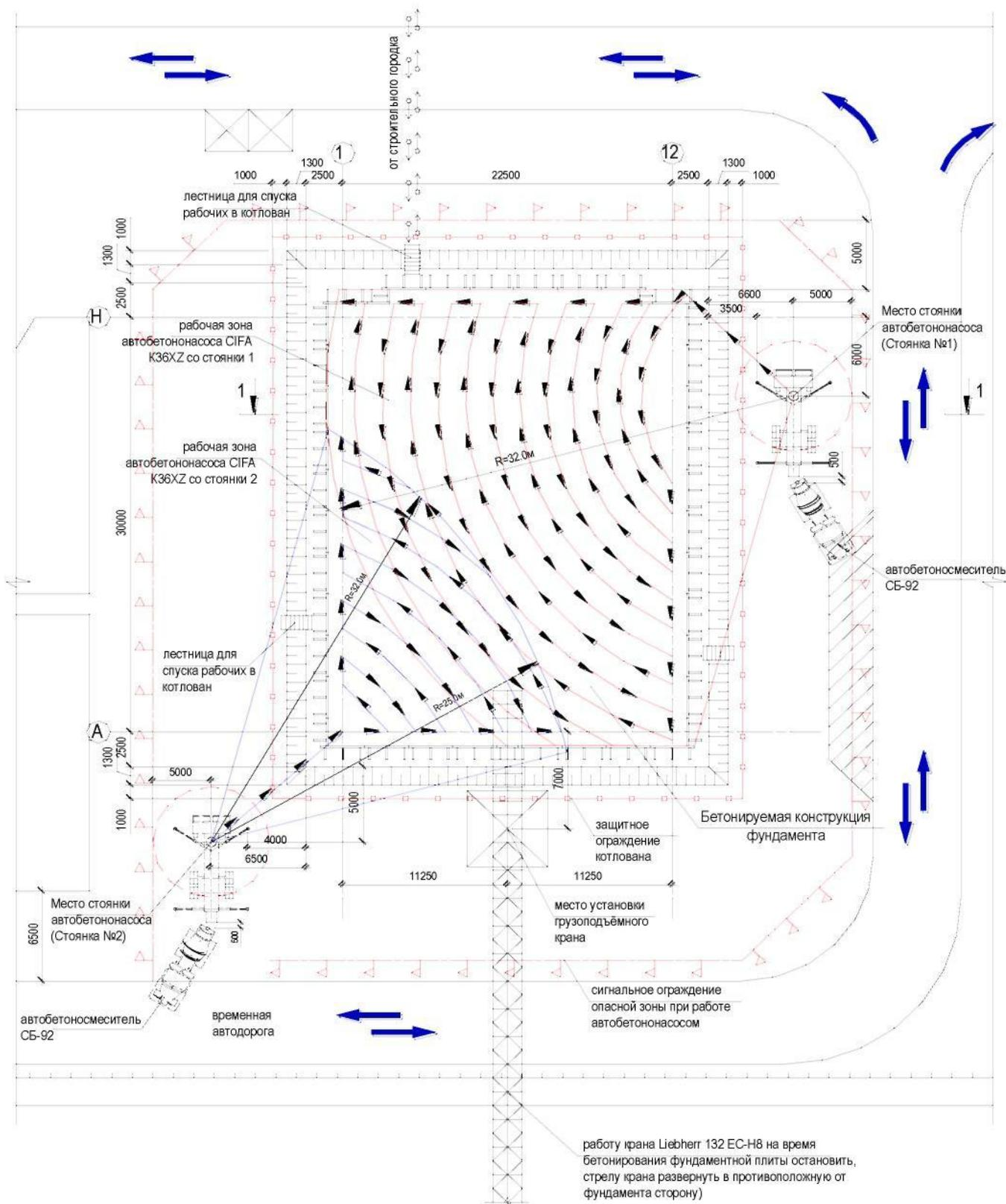
Рис. 32. Схема производства работ по бетонированию фундаментной плиты
