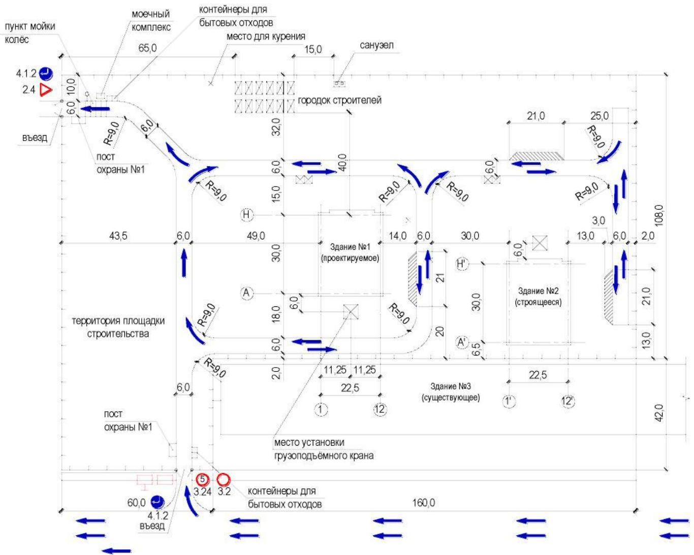
Рис. 15. Место установки башенного крана
