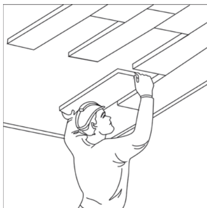
Рисунок 6.11 – Установка плит теплоизоляционных на перекрытие
