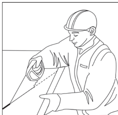
Рисунок 6.1 – Раскрой теплоизоляционных плит с использованием ножовки ручной
