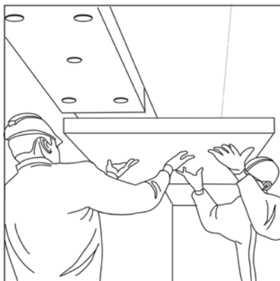
Рисунок 6.4 – Установка теплоизоляционной плиты к месту монтажа
