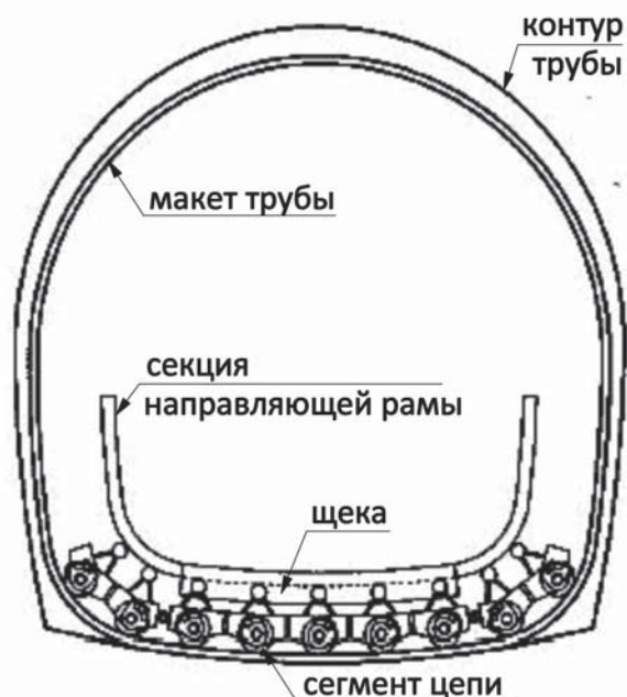
Рисунок 7 – Первый этап сборки навивочной машины
