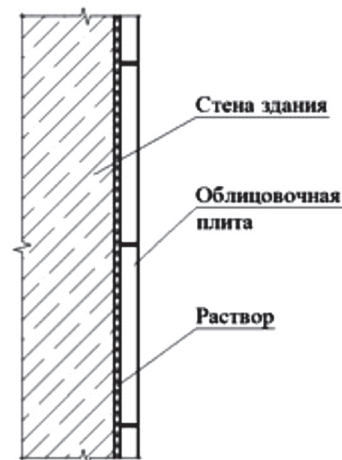
Рисунок 4 – Схема устройства облицовочного слоя тип 4 (рядовой участок)
