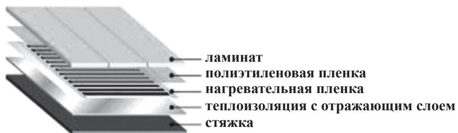
Рисунок Е.3 – Слои пола при установке нагревательной секции на основе нагревательной пленки
