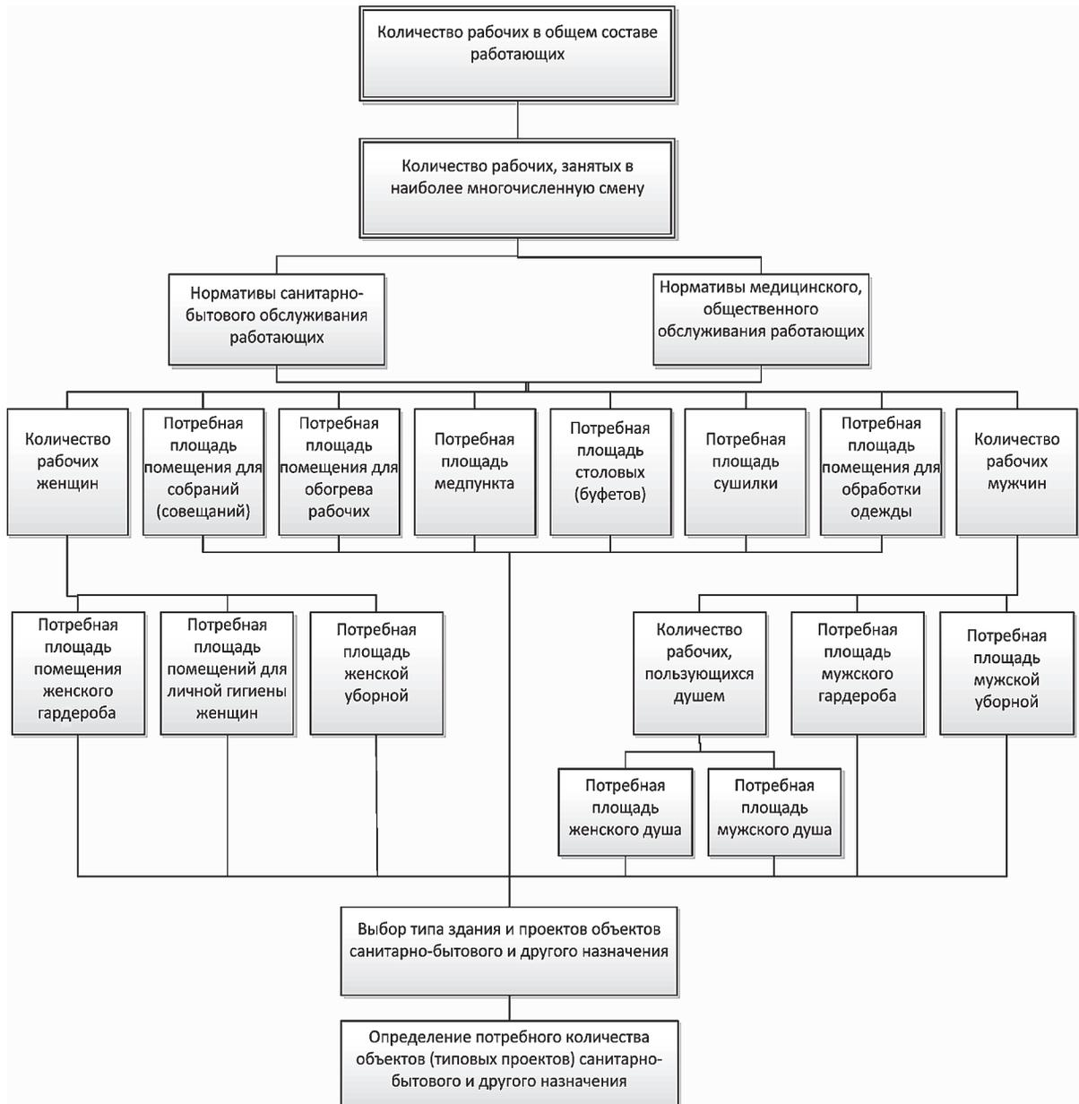
Рисунок 3 – Последовательность расчета потребности в мобильных зданиях
