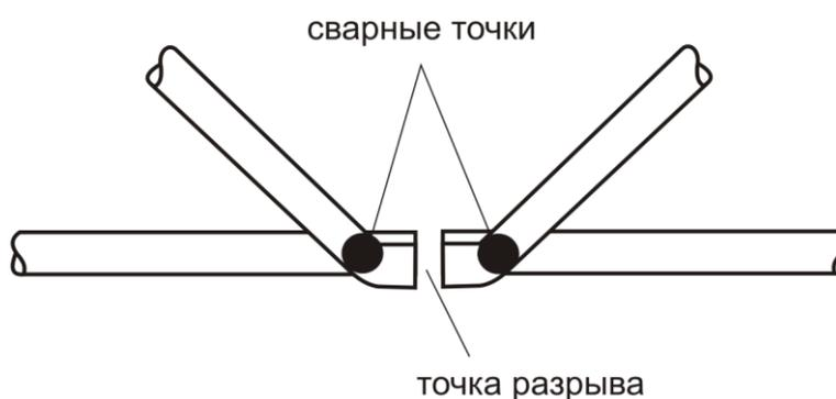
Рисунок Г.1 – Образец для испытания с двумя сварочными соединениями.
