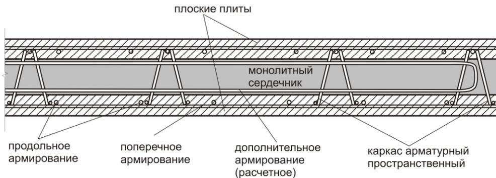
Рисунок 2 – Конструкция сборно-монолитной стены с арматурным пространственным каркасом
