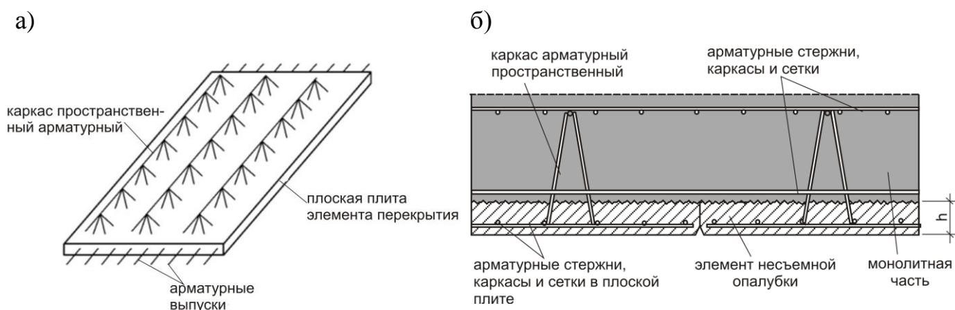
Рисунок 4 – Элемент несъемной опалубки перекрытия а) и сборно-монолитный элемент б)
