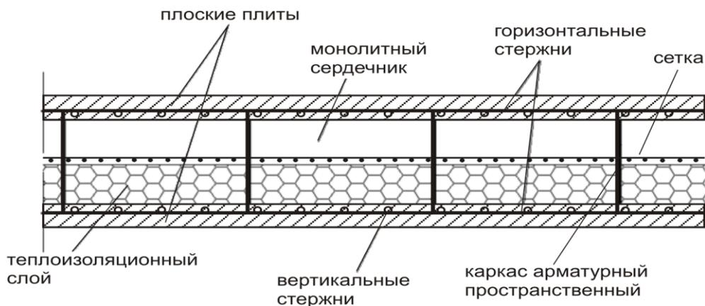
Рисунок 3 – Элемент несъемной опалубки трехслойных наружных стен
