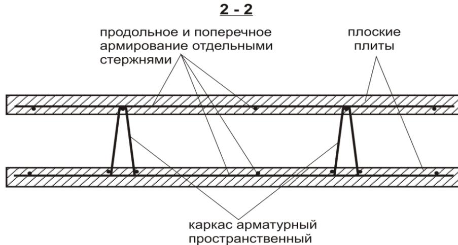
Рисунок 1 – Элемент несъемной опалубки стен
