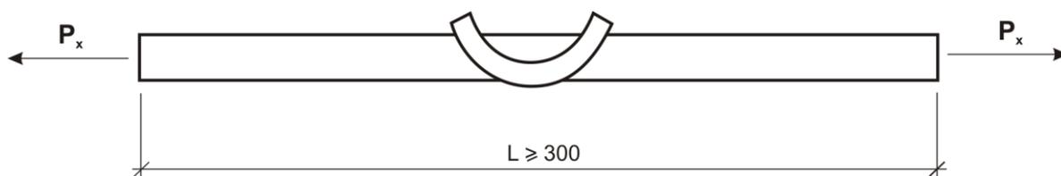
Рисунок Г.2 – Схема испытания на растяжение продольного стержня нижнего пояса со сварным соединением
