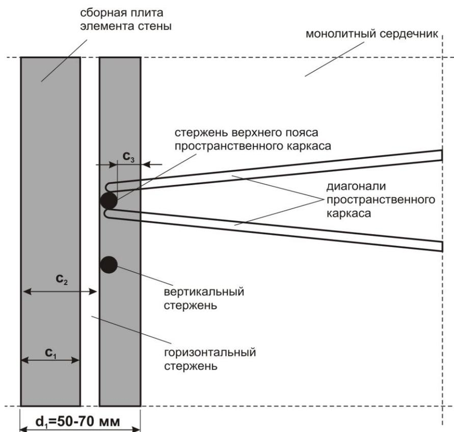
Рисунок Б.1 – Фрагмент элемента несъемной опалубки стены
