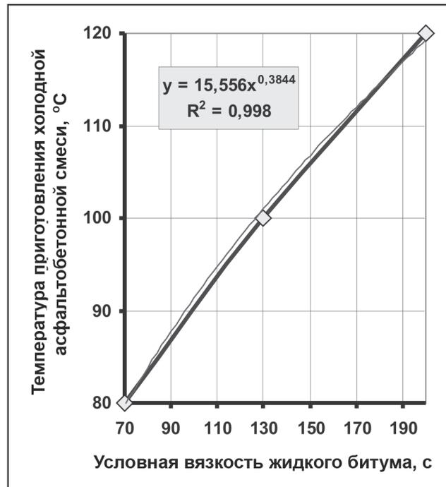
Рисунок В.1 – Температура приготовления холодной асфальтобетонной смеси
