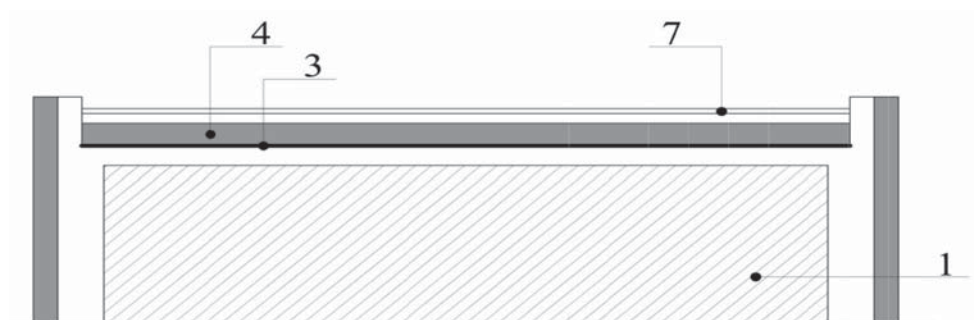
г – утепленная совмещенная плоская крыша
