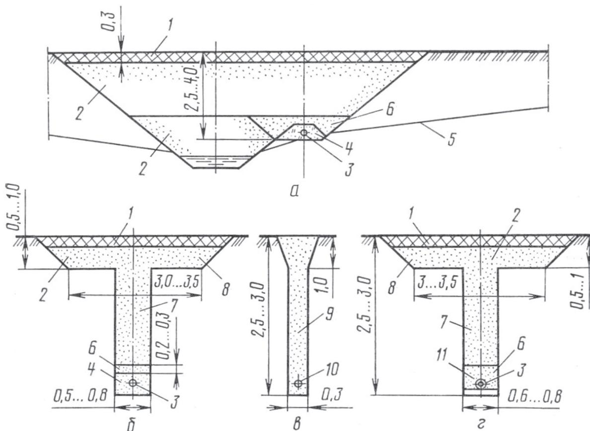
*a* – закрытой, устраиваемой методом «полки» (в водонасыщенных грунтах); *б* – закрытой с песчано-гравийным фильтром; *в* – бестраншейной пластмассовой; *г* – закрытой с минерально-волокнистым фильтром;
