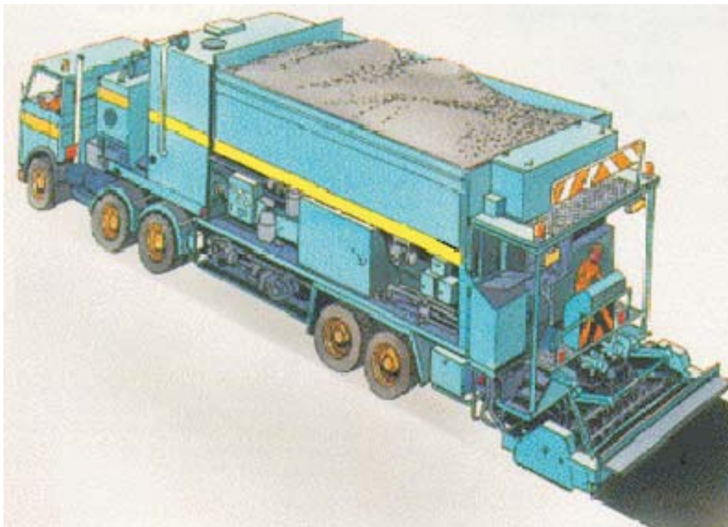
Рисунок С.2 – Общий вид машины для устройства литой эмульсионно-минеральной смеси
