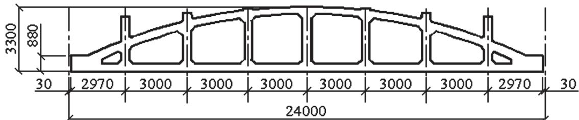
Рисунок 4 – Безраскосная ферма для покрытий с малоуклонной кровлей
