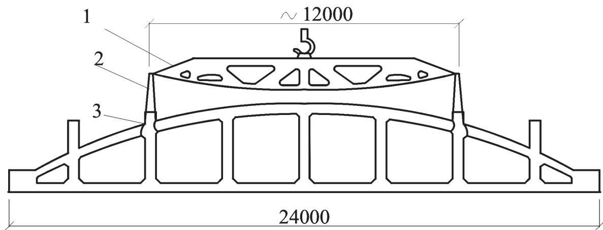
1 – траверса; 2 – строп ВК-4/5000; 3 – автоматический захват
