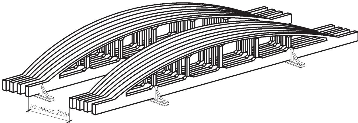
Рисунок 6 – Схема опирания при транспортировке и хранении ферм
