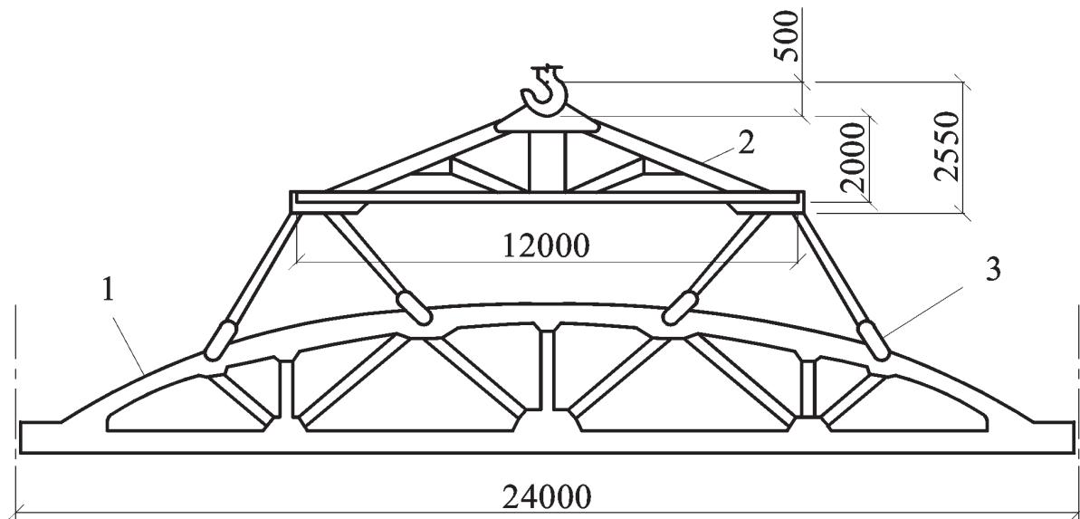
1 – ферма; 2 – траверса; 3 – полуавтоматический металлический захват
