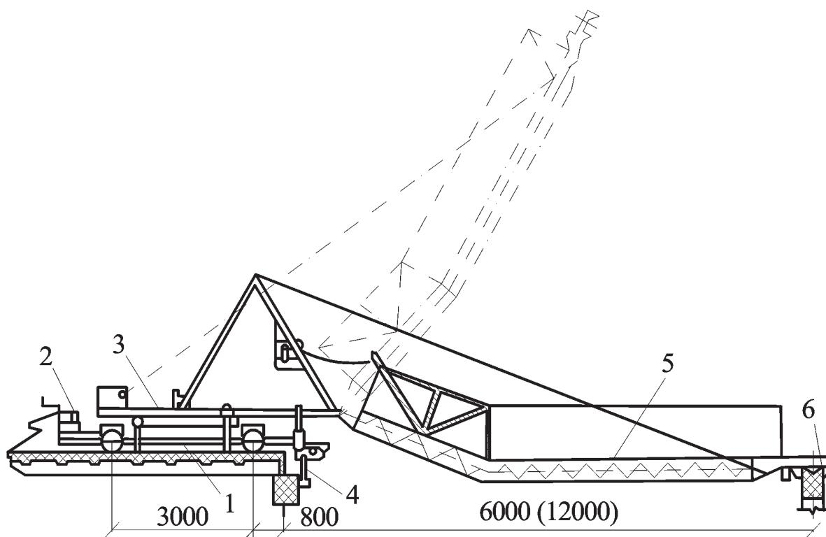
1 – тележка; 2 – натяжное устройство; 3 – каретка; 4 – фиксирующий упор;
