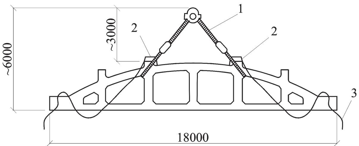
1 – строп; 2 – пружинный замок Пр8; 3 – канат для расстроповки
